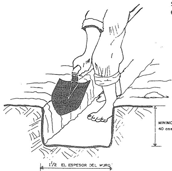
Es importante que las excavaciones para cimientos se hagan hasta encontrar suelo firme y a no menos de 40 cms. El ancho de éstas debe ser como mínimo una y media veces el espesor del muro.
