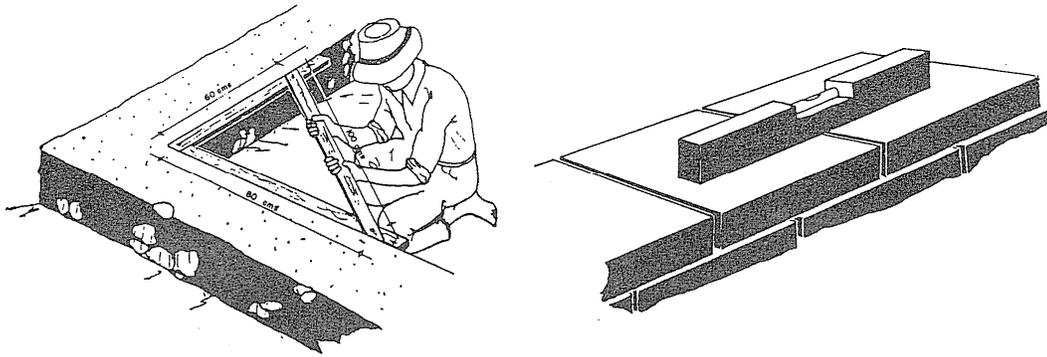
La construcción de las bases, la cimentación y muro se deben hacer perfectamente nivelada y a escuadra.
